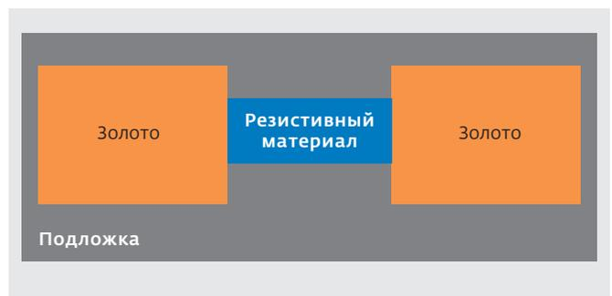
Рис.9. Микрополосковый чип-резистор
